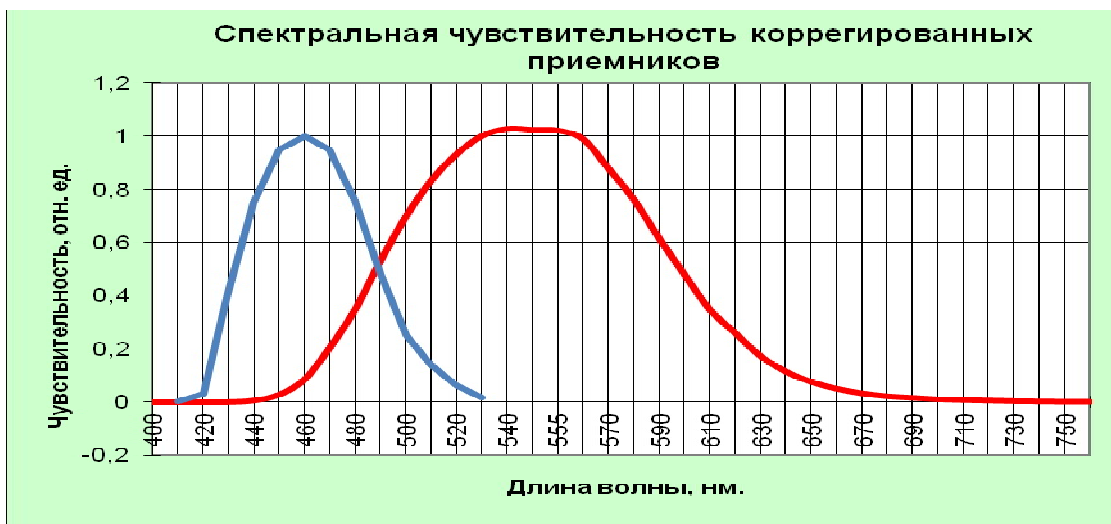
Рис. 4. Спектральная чувствительность "синего" и "красного" фотоприемников.
