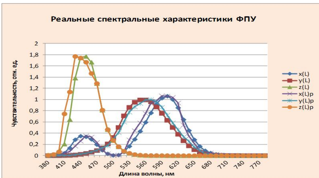
Рис. 2. Реальные спектральные характеристики скорректированных фотоприемников интегрального колориметра.
