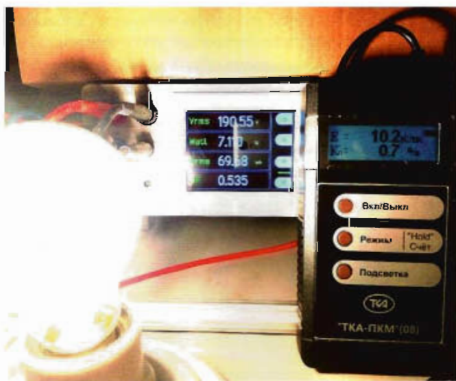
Рис. 11. Измерение K_n у типовой светодиодной лампы с импульсным драйвером
