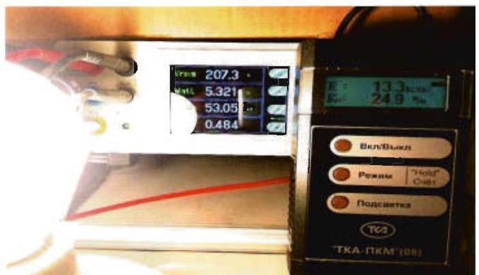
Рис. 9. Измерение K_{\Pi} у типовой светодиодной лампы с линейным драйвером
