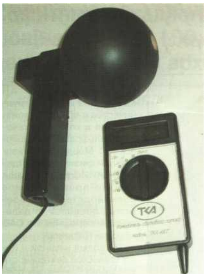
Рис. 3. Внешний вид опытного образца прибора «ТКА - ККТ», предназначенного для измерения светового потока светодиодов
